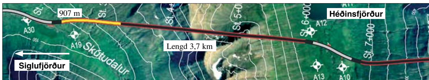
Staða framkvæmda við Héðinsfjarðargöng 12. febrúar 2007. Búið er að sprengja 907 m í Siglufirði og 606 m í Ólafsfirði.
